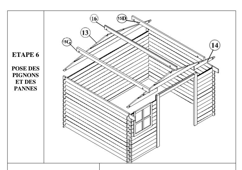
Quand les 4 parois sont prêtes, installez le **pignon arrière** (pièce N°13) et **le pignon avant entaillé** (pièces N°14) dans les entailles prévues sur les madriers latéraux supérieurs. N'hésitez pas à jouer avec les cadres latéraux pour faciliter l'insertion du pignon avant entaillé.
