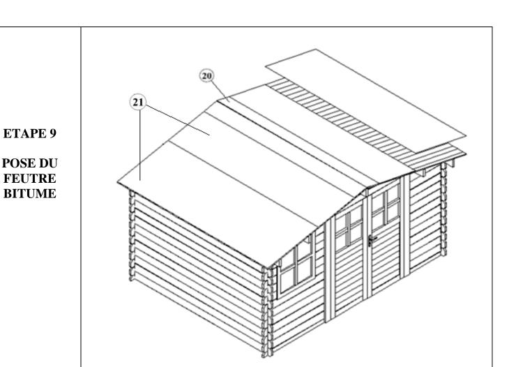
C'est le moment de la pose du **feutre de toiture bitume** (pièces N° 20).
