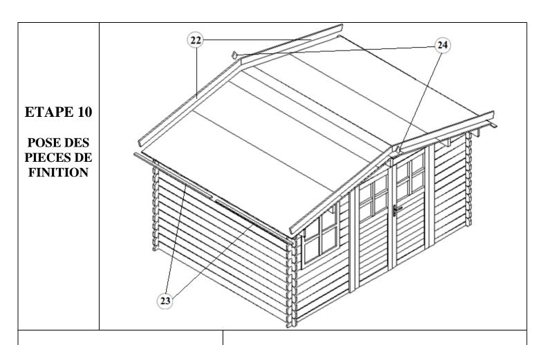
Maintenant continuez par monter **les planches de rive** (3 vis par planche) **avant et arrière** (pièces N°22) et **les losanges** (2 vis par pièce) (pièces N°24) avec les vis 4x40.
