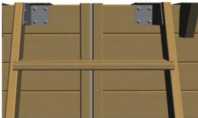
Figure 17 – Fixation de l'escalier extérieur sur le bassin
