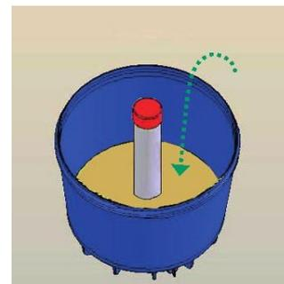
Verser doucement 20 kg de sable dans le filtre et l'étaler à la main.
