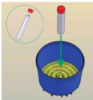
Vérifier que le plancher filtrant est bien en place au fond de la cuve. Insérer le tube collecteur coiffé de son bouchon de protection dans le trou au milieu du plancher filtrant.
