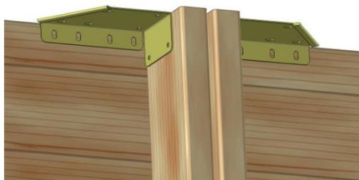
Figure 18 - Mise en place des équerres de margelles en haut des jambes de force
