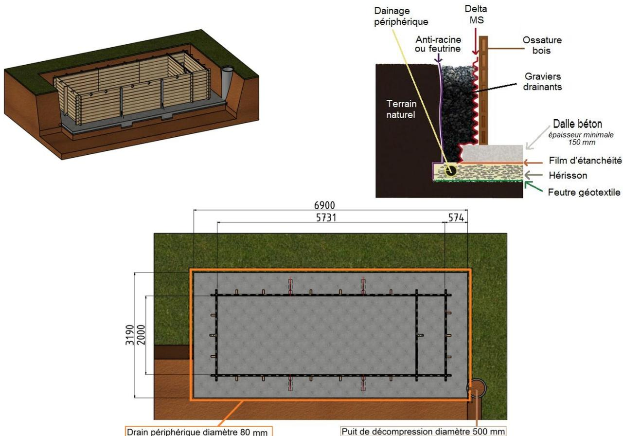
Figure 1 - Plan de pose du système de drainage
