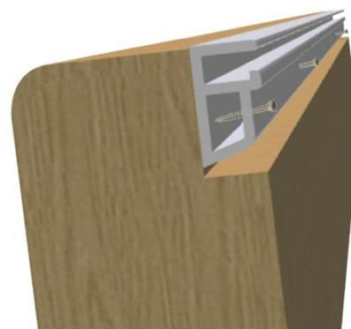
Figure 26 - Pose du rail d'accrochage
