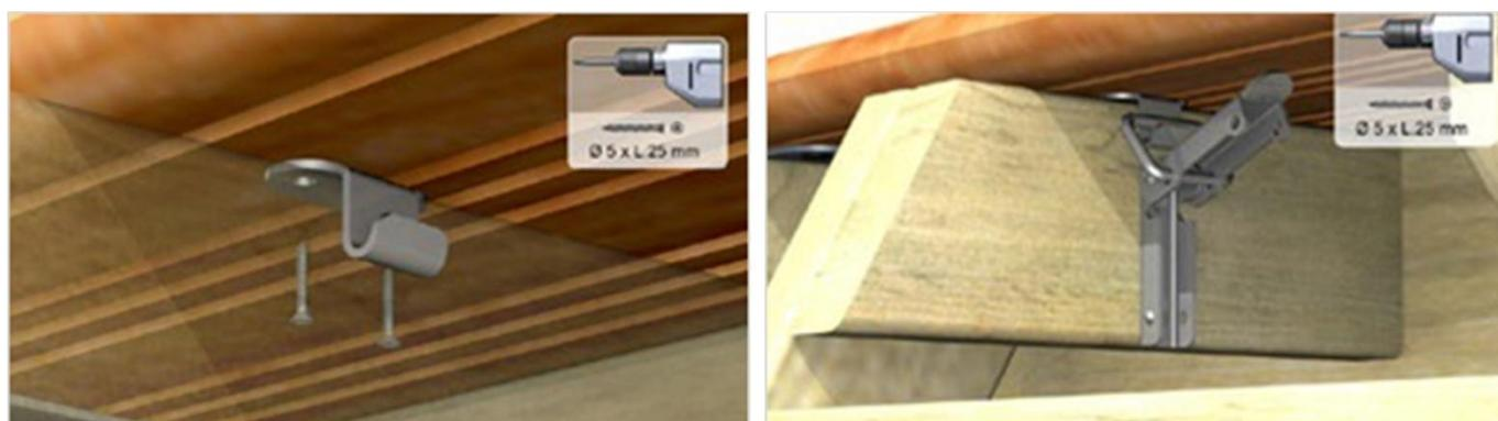
Figure 38 – Montage du système crochet – grenouillère
