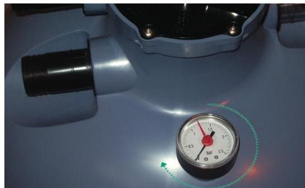
Par le dessous du couvercle, vissez l'écrou laiton à la main puis serrez modérément à la clé à pipe de 22 afin de ne pas détériorer le joint.
