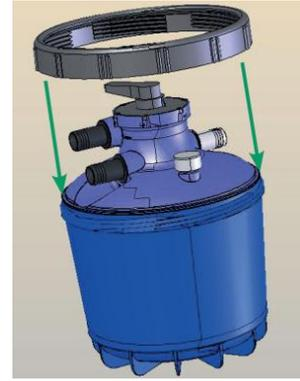
Présenter le couvercle au dessus de la cuve. Enfoncer le couvercle dans la cuve en un point. Conserver l'appui sur ce point à l'aide du genou.
