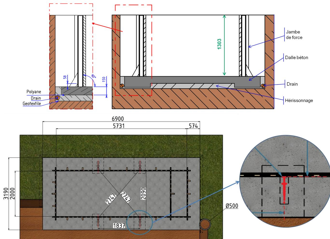
Figure 4 - Positionnement des jambes de force
