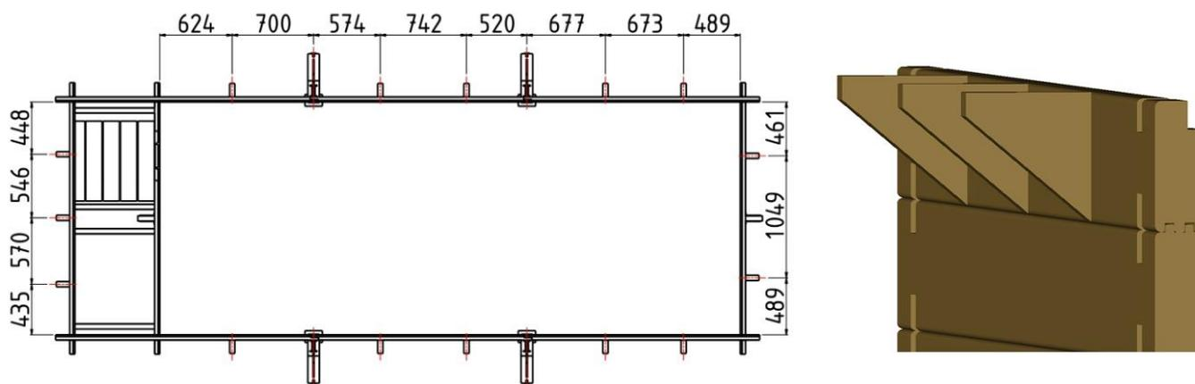
Figure 16 - Emplacements des consoles de margelles
