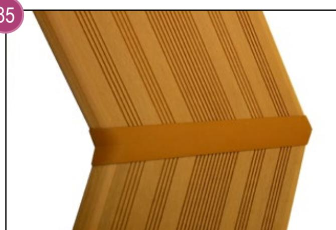
La margelle en bois composite est équipée de profils de jonction. La pose s'effectue comme décrite pour la margelle en Pin à la différence qu'il est nécessaire de laisser un intervalle entre chaque module de margelle afin de permettre la pose des profils de finition, ceux-ci venant se clipser à l'aide d'une légère torsion. La margelle composite ne nécessite pas la pose de pièces de maintien sous les angles de margelle (illustration 81).
