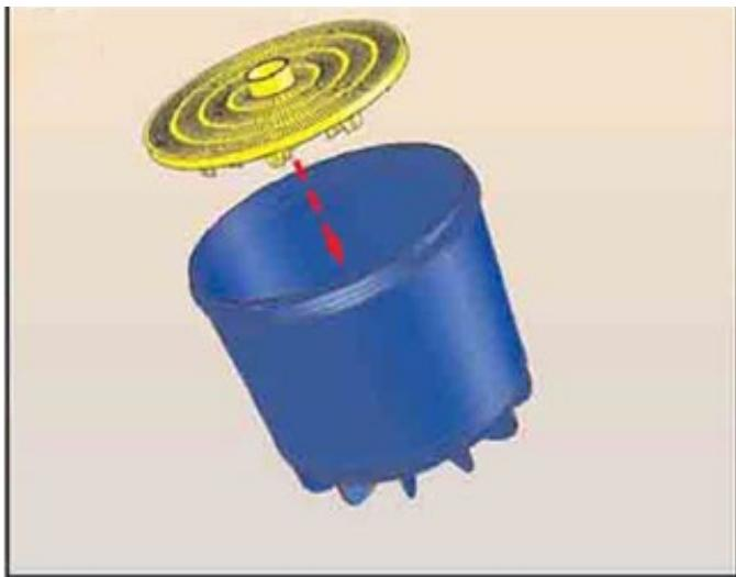
Déposez le plancher crépiné au fond de la cuve.
