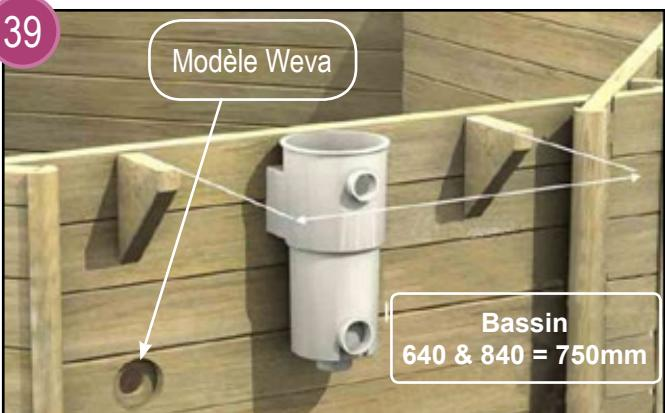
Sur la paroi recevant le skimmer, les consoles au nombre de 2 sont positionnées de part et d'autre de l'axe du skimmer .
