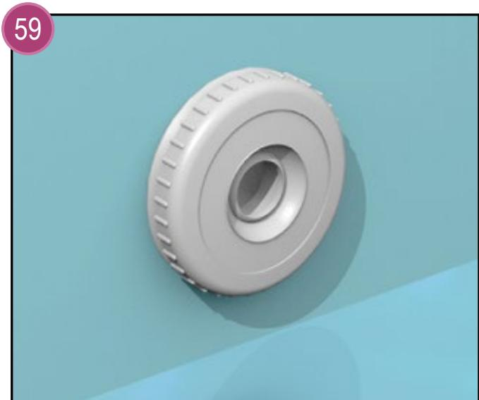
Vissez l'ensemble rotule orientable sur le corps du refoulement. La rotule devra être orientée vers la gauche pour favoriser un mouvement d'eau nécessaire au bon fonctionnement de la filtration. (Afin de faciliter l'utilisation du jet orientable, ainsi que le démontage de ce dernier lors de la mise en hivernage, veillez lors de son montage à appliquer une graisse silicone sur la rotule et sur le porte rotule).
