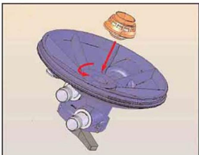
Insérer le diffuseur dans le couvercle et le verrouiller par rotation en sens **inverse** des aiguilles d'une montre.
