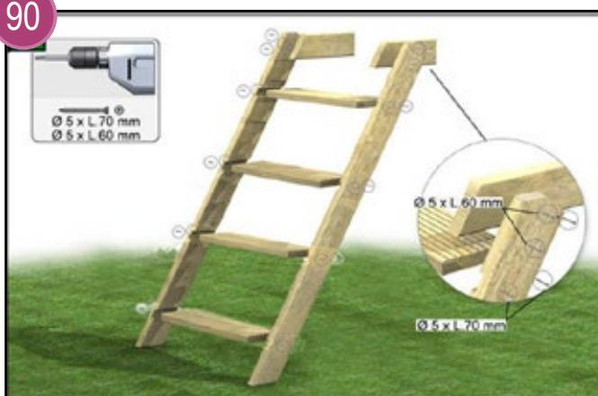
Vous trouverez les limons (côtés) de l'échelle ainsi que les marches dans le kit bois de votre piscine. Assemblez l'échelle en utilisant les vis inox (sachet K). Pour un assemblage plus efficace et plus propre, il est vivement conseillé de pré-percer au diamètre de 4 mm avant vissage et de fraiser les avant-trous afin d'éviter de fendre le bois et provoquer des échardes.
