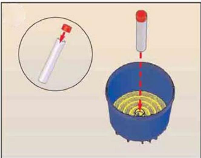
Coiffez le tube plongeur avec le bouchon de protection et l'insérer dans le trou au milieu du plancher crépiné.
