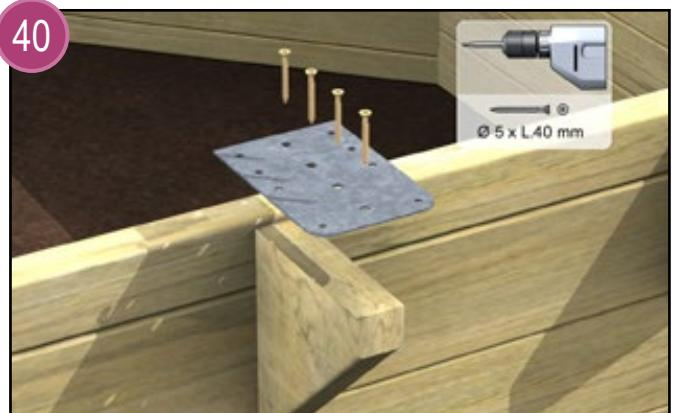
Fixez sur chaque console une plaque (kit console) destinée à la mise en place de la margelle. Veillez à ce que chaque plaque soit bien positionnée à fleur du haut des parois. Effectuez un fraisage sur les perçages des plaques avant vissage.
