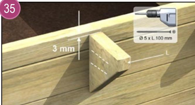
Les consoles sont destinées à soutenir la margelle qui sera mise en place après le remplissage du bassin. Fixez, après avoir prépercé les parois, chaque console (type L) à l'aide de 2 vis (sachet 1 vis 5x100mm) de l'intérieur de la piscine en prenant soin de les positionner à 3mm sous la partie supérieure de la structure. Veillez à contrôler l'aplomb de chaque console.
