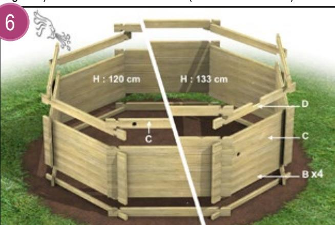
Emboîtez l'ensemble des parois restantes (type B) en prenant soin du positionnement de la paroi de refoulement (type C) et de la paroi usinée (type D). La paroi de refoulement (type C) doit être positionnée au-dessus de 4 (type B) + 1 paroi (type A). La seconde paroi percée (C) est destinée à la prise balai. Observez sa position sur l'éclaté en fin de notice. La paroi de type D est située sur le même côté au dernier rang de cette étape de montage.
