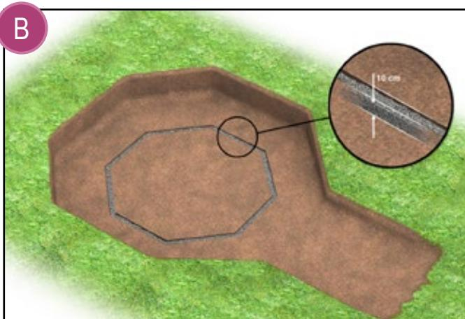
Une fois la tranchée faite, comblez sur environ 10 cm avec du gravier de faible granulométrie. Afin d'éviter un tassement qui se répercute sur la structure de la piscine, veillez à bien le compacter. Achevez le comblement avec du sable compacté. La tranchée comblée doit être au même niveau que le sol.
