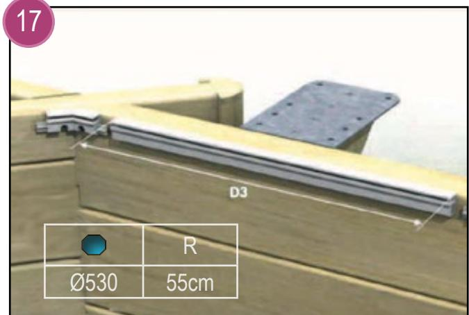
Positionnez et fixez à chaque angle de la piscine les pièces de jonction d'angle (blister jonctions+angles) à l'aide de 2 vis inox (sachet E) dans les encoches prévues à cet effet. Veillez à ce que les pièces soient bien affleuré du haut de la paroi. Chaque pan de paroi reçoit une longueur de rail de 1,18m + une longueur complémentaire à couper.
