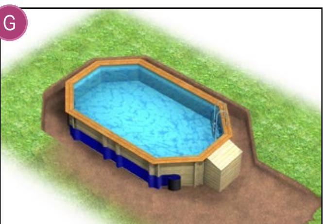
Effectuez le montage de votre piscine comme indiqué dans la notice. Réalisez la pose de la protection extérieure (film plastique spécial fondation non fourni) jusqu'à hauteur du futur remblai.
