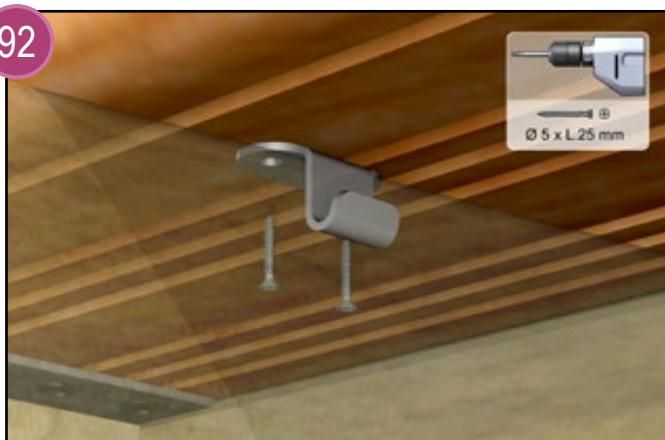
L'échelle bois est équipée de deux fermetures à levier permettant un verrouillage efficace de celle-ci. Les parties levier sont à fixer sur les supports d'échelle et les crochets sous la margelle (vous trouverez ces pièces dans le sachet K). Il est nécessaire d'étudier le fonctionnement de ces 2 pièces ensemble pour en comprendre le fonctionnement et évaluer la course nécessaire à un verrouillage efficace de l'échelle une fois en place.
