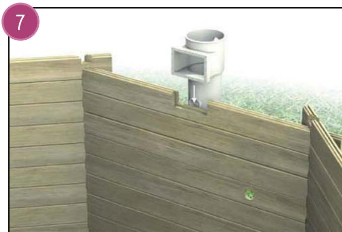
A ce stade, il est nécessaire d'engager le skimmer ou bloc de filtration dans la paroi usinée (type D).
