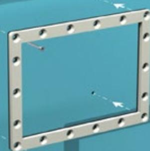
Repérez au travers du liner les trous des 4 angles de la fenêtre du skimmer et marquez-les au stylo.
