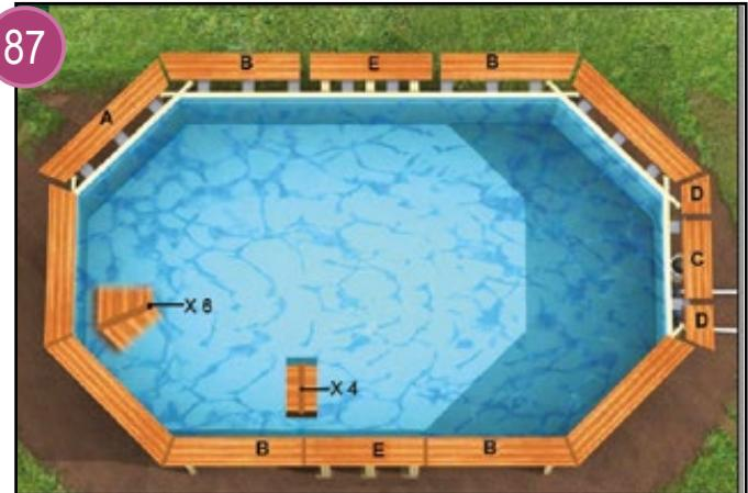
La margelle en bois composite est équipée de profils de jonction. La pose s'effectue comme décrite pour la margelle en Pin à la différence qu'il est nécessaire de laisser un intervalle (+/8mm) entre chaque module de margelle afin de permettre la pose des profils de finition, ceux-ci venant se clipser à l'aide d'une légère torsion (reportez-vous aux illustrations 84 et 85). La margelle composite ne nécessite pas la pose de pièces de maintien sous les angles de margelle (illustration 81).
