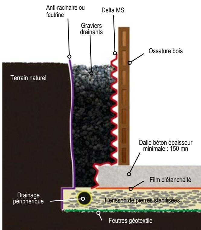
Le Delta MS permet de ventiler la structure bois du bassin.
