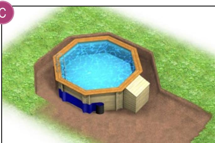
Effectuez le montage de votre piscine comme indiqué dans la notice. Réalisez la pose de la protection extérieure (film plastique spécial fondation non fourni) jusqu'à hauteur du futur remblai.
