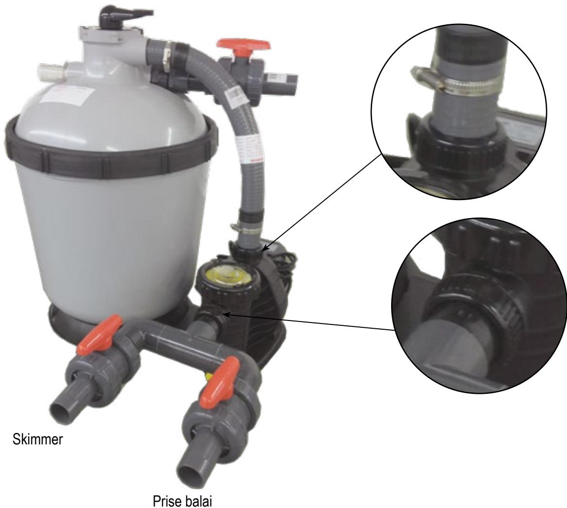
Assemblez la pompe sur son socle, puis connectez l'ensemble au socle du filtre. Veillez à l'orientation de l'ensemble afin de faciliter ultérieurement le raccordement des tuyaux semi-rigide.
