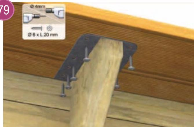
Fixez les planches à l'aide de vis penture (sachet G ou H) sur les plaques métalliques des consoles en effectuant le vissage par dessous comme indiqué. Effectuez un léger pré-perçage pour faciliter la mise en place. Contrôlez au fur et à mesure le bon alignement de l'ensemble.
