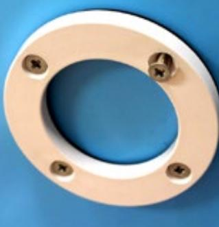
Effectuez le vissage de la bride équipée de son joint adhésif à l'aide des vis inox FZ M5x16 du skin pièce à sceller. Veillez lors de cette opération à effectuer un serrage alterné afin de garantir une parfaite étanchéité. Privilégiez un serrage manuel afin d'éviter un serrage trop brutal risquant de fendre la bride.
