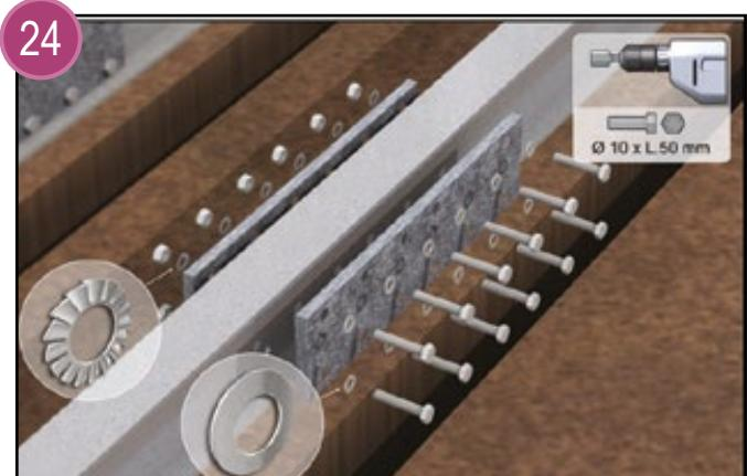
Approchez du bord des saignées les éléments qui composent les berceaux et assemblez-les (à l'aide du kit platine berceaux).
