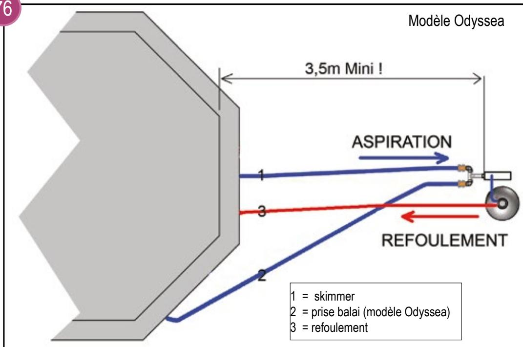
Effectuez, suivant le schéma ci-dessus, le raccordement des tuyaux entre les descentes rigide et le groupe de filtration. La bobine de tuyau fournie dans le kit filtration de votre piscine est dimensionnée pour une installation de base (c'est à dire hors local technique fermé à clef) du groupe à 3,5m du bassin (distance minimale de la pompe par rapport au bassin selon la norme électrique C15-100).
