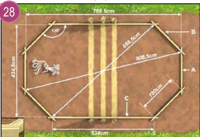
Emboîtez les 2 demi - parois (type A) et les 2 demi - parois ( type C) avec 4 parois (type B) comme illustré, les parties mâle (double languette) étant orientées vers le haut (voir détail ci dessous).
