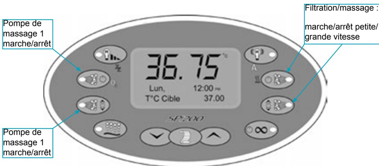
Touches de marche/arrêt des pompes sur le panneau de commande SP1200
