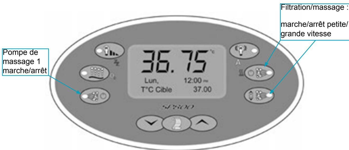
Touches de marche/arrêt des pompes sur le panneau de commande SP800 / SP800X
