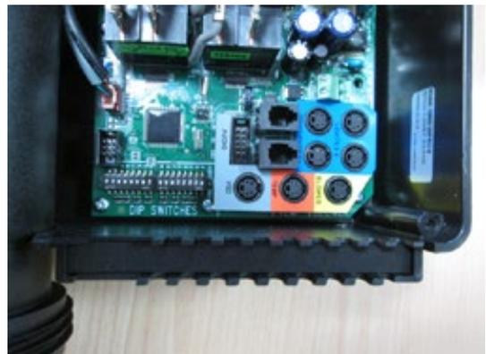
Introduire les câbles électriques venant du spa dans le coffret par les fentes situées sur sa droite. Chaque câble est identifié par une couleur différente. Les câbles à raccorder sont :
