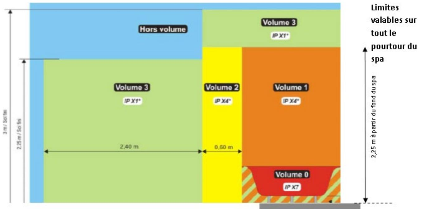
**Volume 0** : pas d'appareillage électrique autres que ceux intégrés au spa
