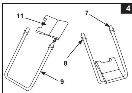
5. Les pieds en U sont équipés de double clips montés préalablement en usine. Insérez les pieds en U dans les trous des poutres horizontales en appuyant avec vos doigts sur les double-clips. Lorsque le pied est à l'intérieur de la poutre, relâchez le clip et la poutre se mettra en place en faisant un claquement. Répétez cette opération pour chacun des pieds (**voir dessin 5**).
