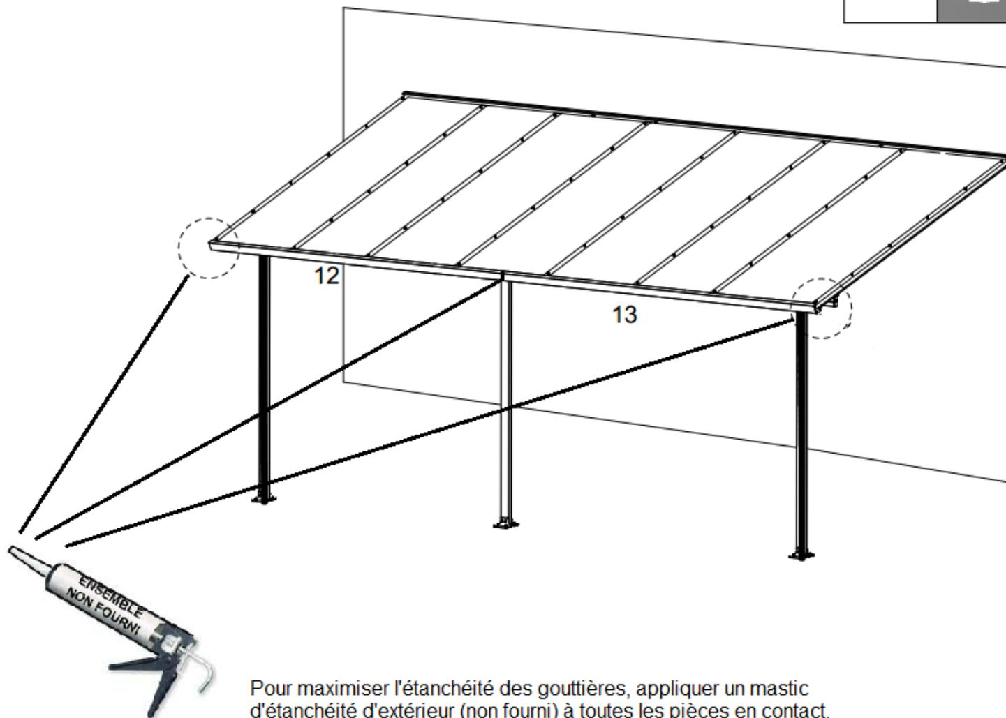
Pour maximiser l'étanchéité des gouttières, appliquer un mastic d'étanchéité d'extérieur (non fourni) à toutes les pièces en contact.
